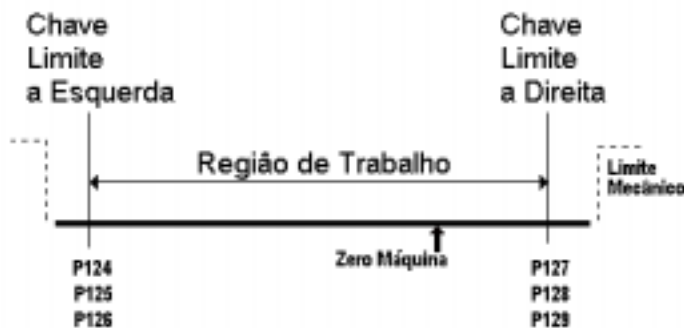
FIGURA 8.7 - Configuração das chaves limites
