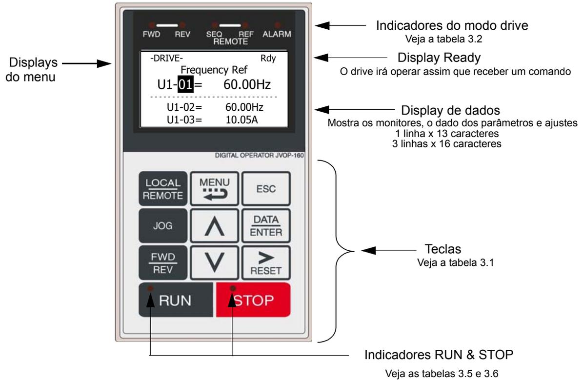
Fig 3.1 Nomes e funções das teclas e displays do operador digital
